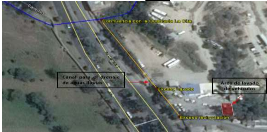
Imagen 2. Ubicación del canal de aguas lluvias o pluvial, costado oriental de la avenida carrera séptima, sentido Sur – Norte. Fuente: Google Earth 2016.
