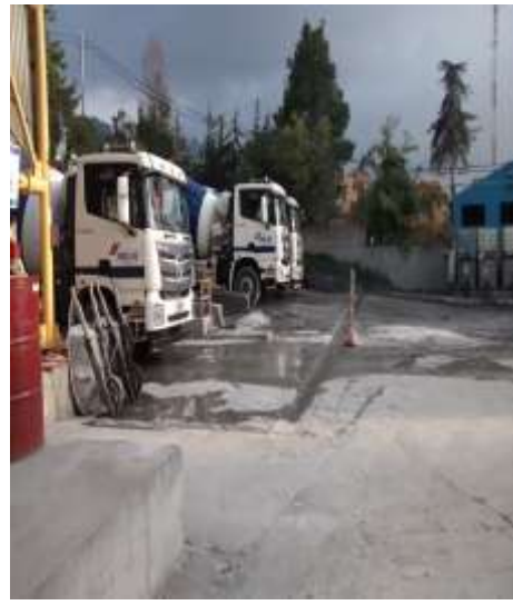
Fotografía 2. Plataforma de lavado de los vehículos mezcladores o mixers.
